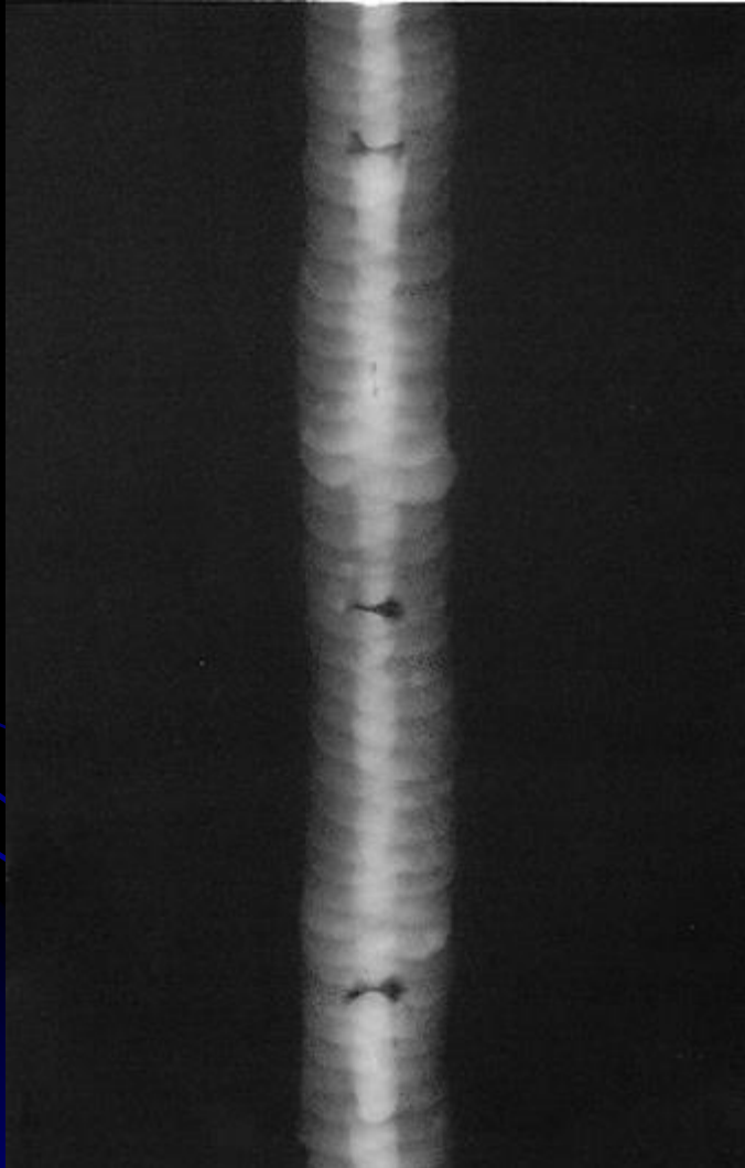
Interpass slag inclusions
