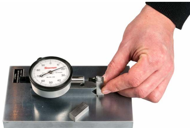
تصویر ۴۲۷: نحوه اندازه گیری مقدار انبساط جانبی با گیج (Guage) مخصوص این کار
