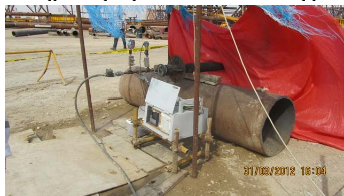
تصویر ۷۳۰: نمایی از لوله و تجهیزات اندازه گیری هیدروتست ( لوله ۴ اینچ با پوشش پلی اتیلن سیاه رنگ که بسیار حساس به دمای محیط است )
