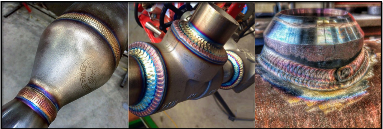
تصویر ۲۷۵: نمونه هایی از اتصالات Branch به Run Pipe و فیتینگها
