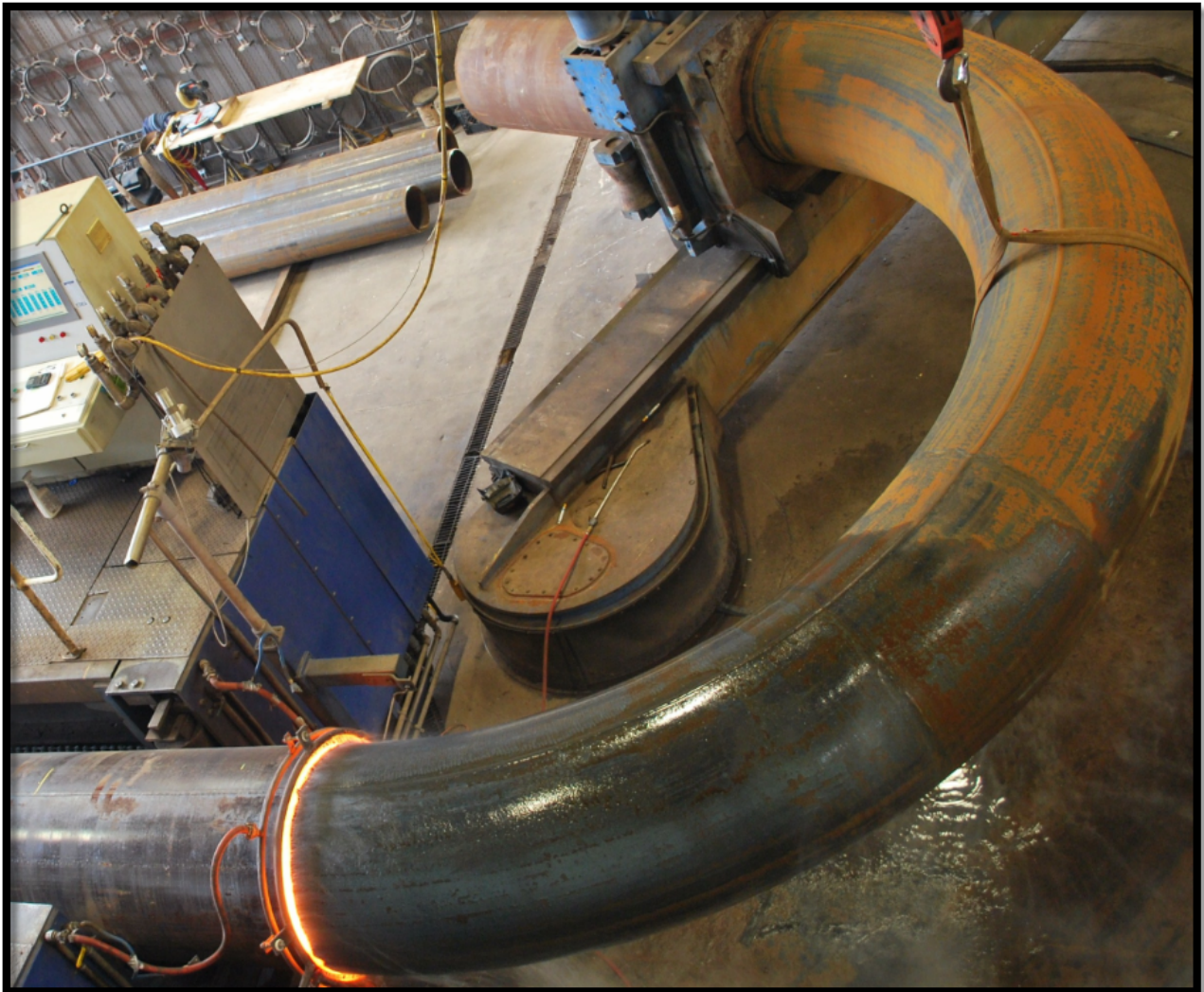
تصویر ۲۹۷: نمایی دیگر از hot bent and hot formed piping
