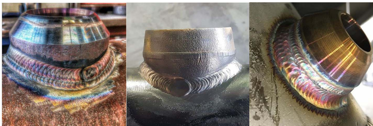
تصویر ۲۷۶: نمونه هایی از اتصالات Branch به Run Pipe و فیتینگها
