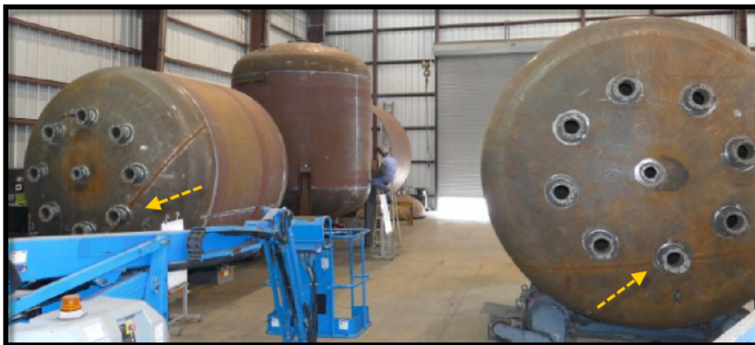
تصویر ۴۹۱: وضعیت نازل روی خط جوش کلگی
