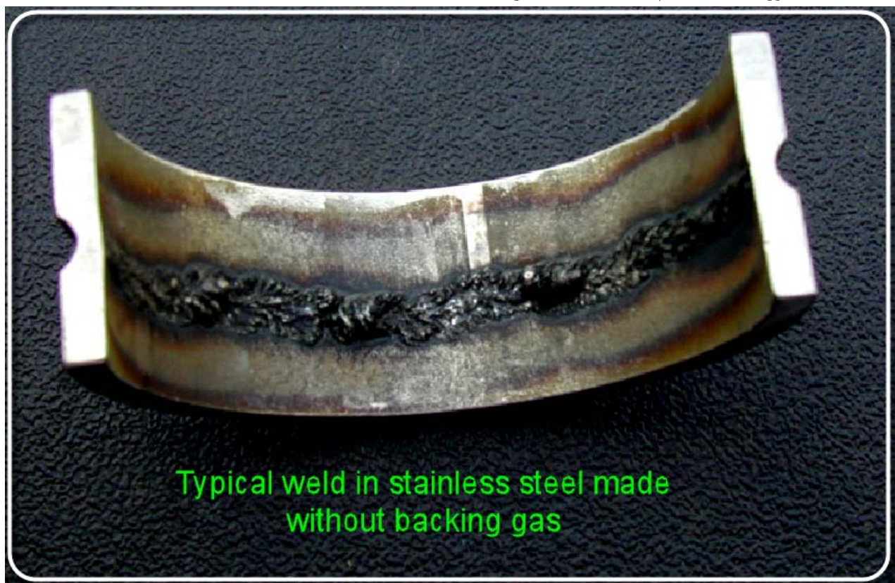
تصویر ۱۵۱: وضعیت جوش پاس ریشه بدون عملیات پرچینگ
