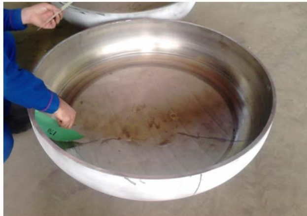
تصویر ۱۱: نحوه‌ی اندازه‌گیری شعاع Knuckle کلگی‌های ساخته شده.
