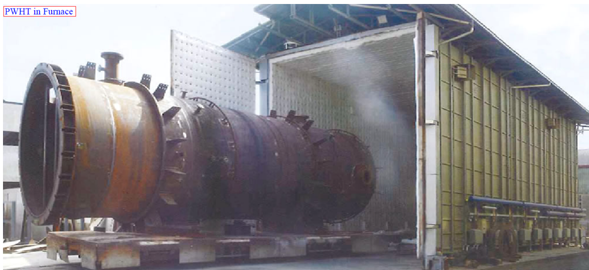
تصویر ۲۲۷: عملیات حرارتی یک مخزن تحت فشار در کوره
