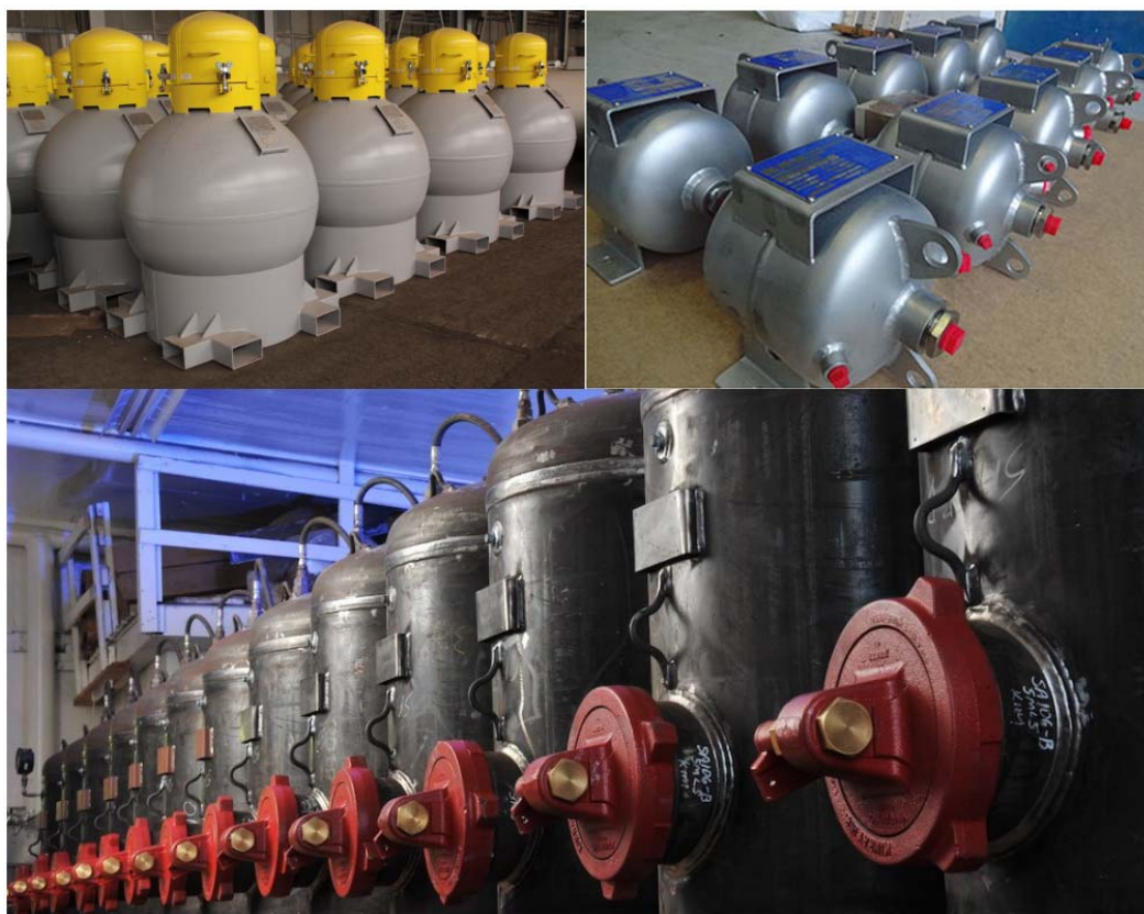
تصویر ۳۲۹: مخازن کوچکی که بصورت دسته ای ساخته می شوند.
