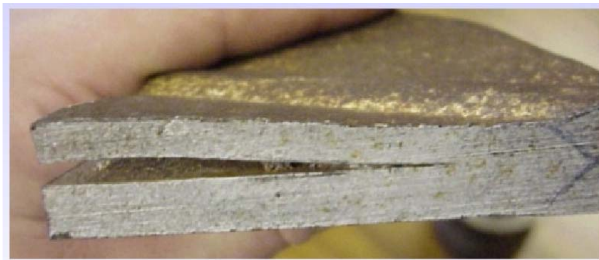
تصویر ۶۲۶: عیب تورق (Lamination)
