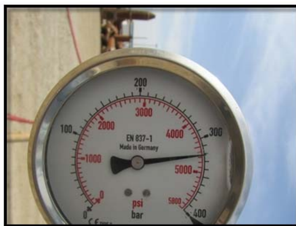
تصویر ۷۳۱: فشار سنج، فشار ۳۲۲ بار در شروع تست را نشان می دهد
