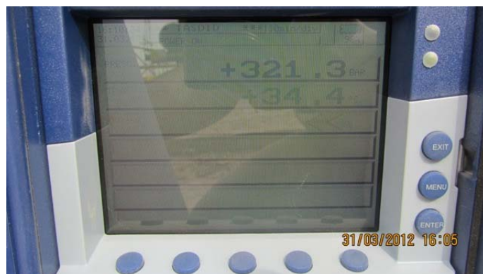
تصویر ۷۲۹: دستگاه ثبت کننده دما و فشار آب هیدروتست
