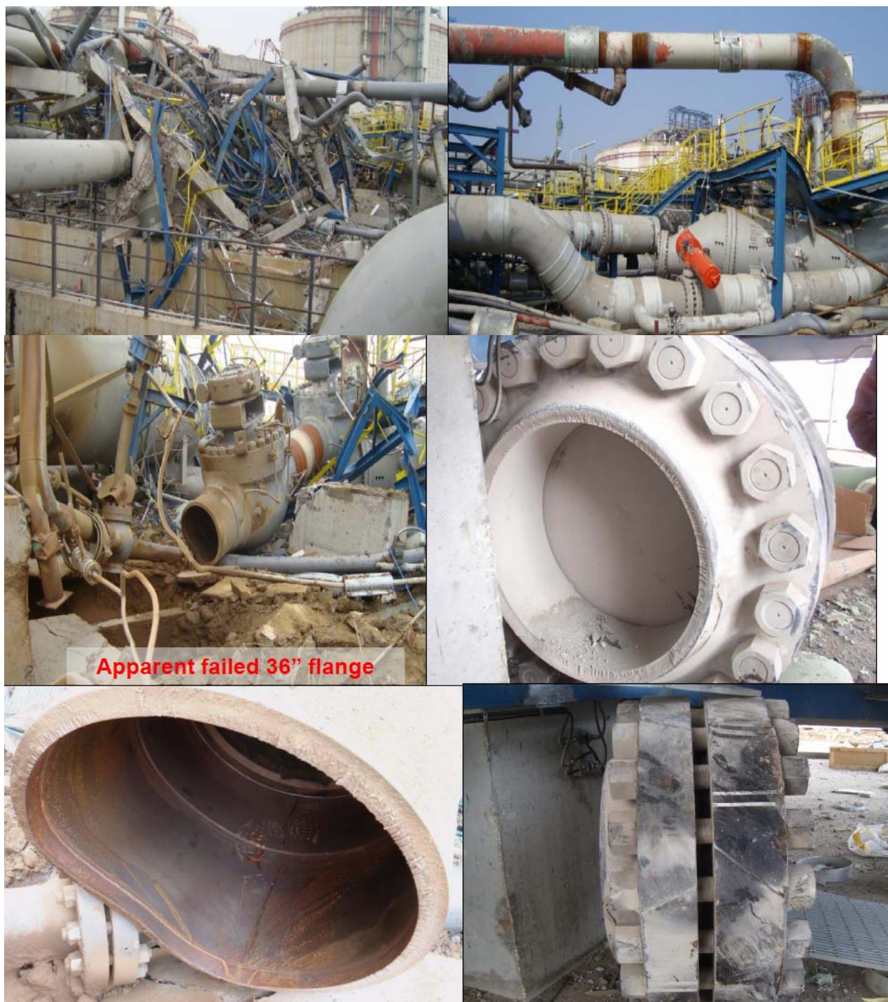
تصویر ۷۲۵: خسارات وارده به تاسیسات یک پالایشگاه در چین در حین انفجار خط 36 in. در حین تست نیوماتیک
